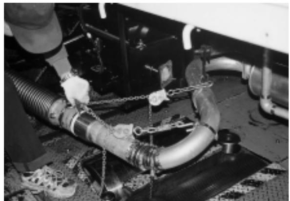
シャーシーダイナモでの試験が始まる前に、試験担当官がチェーンでPM低減装置部分を固定しているところ。装置装着前の試験は低減装置を迂回させる形で排ガスを通して行われた。
