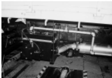
試験はシャーシダイナモに載せた状態で行われる。試験車両は平成元年規制適合車の4トントラック。東京電子サービスの「ニューアクアクリーンPM」はアンモニア方式でNOxを低減するシステムがメイン。
